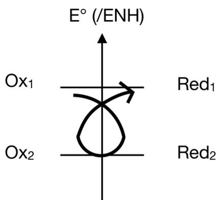
En procédant de même avec la réaction  $2\text{Cr}^{3+}(\text{aq}) + 7\text{H}_2\text{O} + 6\text{Fe}^{3+}(\text{aq}) = \text{Cr}_2\text{O}_7^{2-}(\text{aq}) + 14\text{H}^+(\text{aq}) + 6\text{Fe}^{2+}(\text{aq})$ , le calcul de l'enthalpie libre associée donne  $\Delta rG^\circ_4 = 3,41 \cdot 10^5 > 0$  : la réaction n'est pas spontanée dans le sens gauche-droite et dans les conditions standards.
